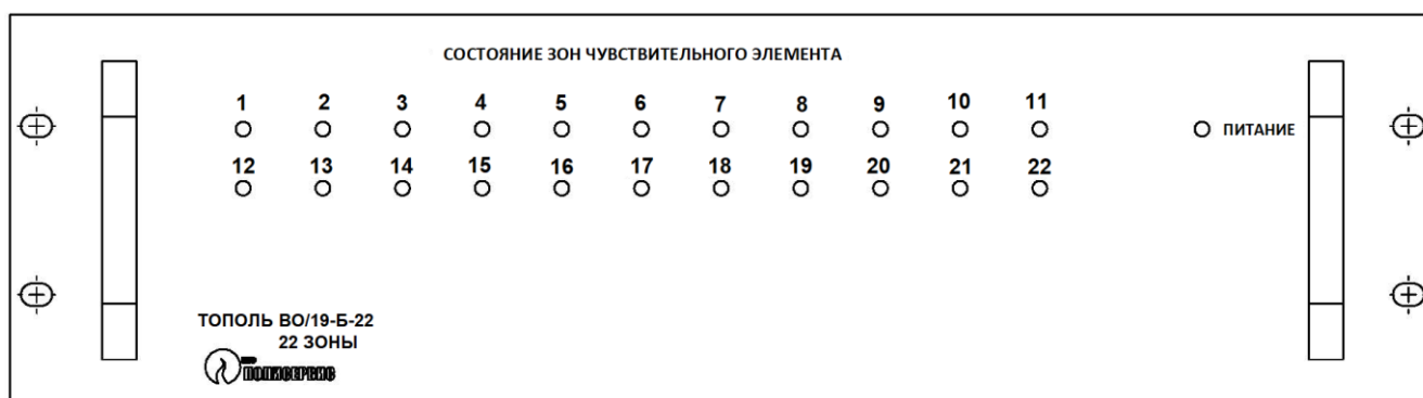
Рисунок 2 - Расположение единичных индикаторов на лицевой панели БОС
